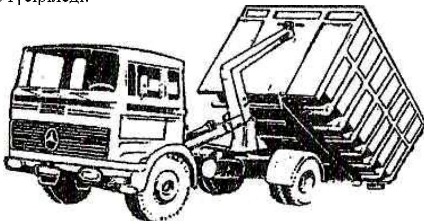
1.9 – сурет - Mercedes-Benz автокөлік шассиіне MeШег фирмасының самосвалды шешіп алынатын кузовы
